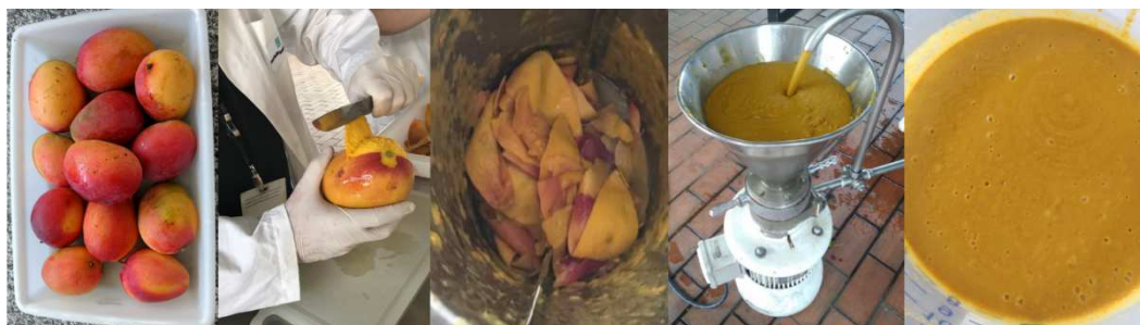
Figura 1: Etapas do processo de preparo da pasta de casca de manga para o drum drying
