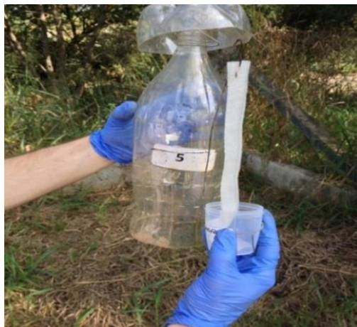
Figura 3. Espuma suspensa na estrutura de arame introduzida na SALE.
